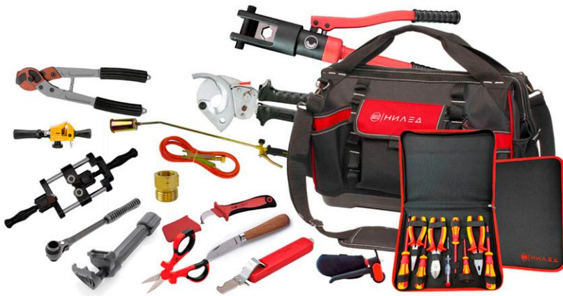
**Набор инструмента СТК** предназначен для выполнения работ по разделке кабелей и монтажу кабельной арматуры.
