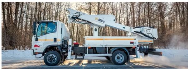
При ПРПН в сетях 6—20 кВ методом «в контакте / в изоляции» основным средством защиты является автоматический изолированный гидроподъемник, обеспечивающий наилучшую защиту работников сетевого предприятия.
