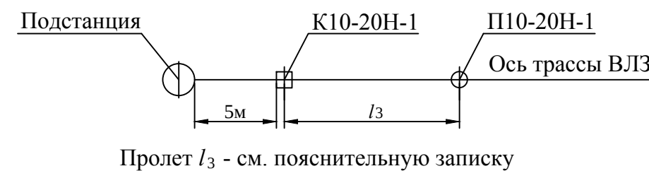
Схема 2 установки на ВЛЗ К10-20Н-1 в качестве концевой опоры
