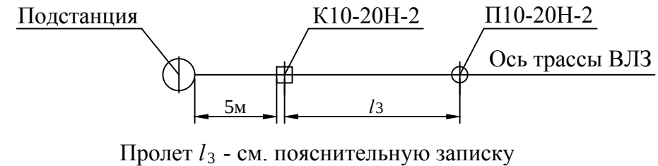
Схема 2 установки на ВЛЗ К10-20Н-2 в качестве концевой опоры
