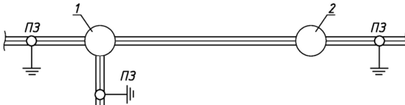
1 - ответвленная опора ВЛ 6-20 кВ, место производства работ;
