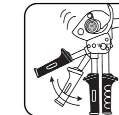
3. Для обрезки кабеля разместите инструмент в месте обрезки кабеля/провода
