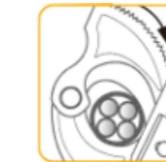
2. Вручную поверните лезвие за внешнюю обойму по часовой стрелке для совмещения лезвий по диаметру проводника
