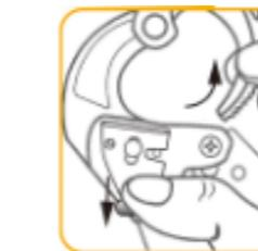
3. Для разъединения ножей, потяните одной рукой за фиксатор/стопор, другой - потяните за внешнюю обойму подвижного лезвия
