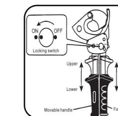
1. Разблокируйте стопорный механизм путем проворачивания шайбы в режиме ON
