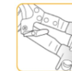
1. Резким нажатием на рукоять, разблокируйте стопорный механизм или нажмите на стопор для снятия фиксации
