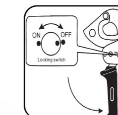
4. После проведения работ, сведите рукоятки и поверните стопорный механизм в режиме OFF
