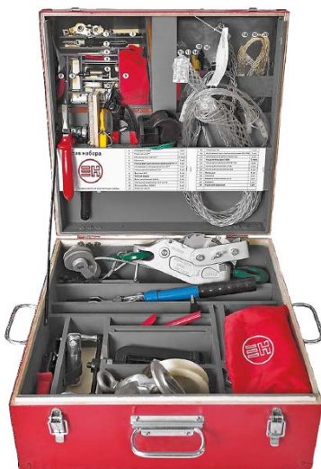
Рис.1. Бригадный штатный набор инструмента ТК-1
